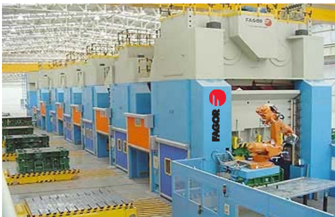
Figura 3 Línea de prensas mecánicas
