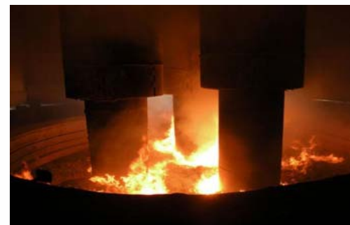
Fabricación de acero (Horno eléctrico de arco)
