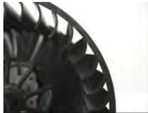
Detalle aspas ventilador interior
