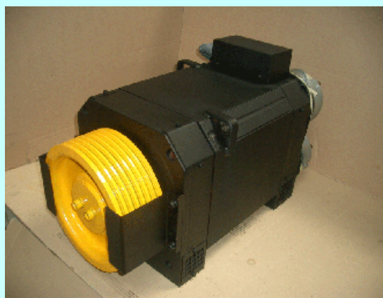
Motor eléctrico de ascensor
