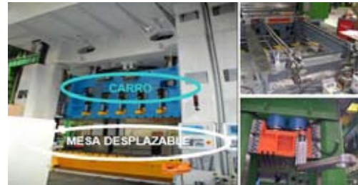
Partes móviles de una prensa hidráulica, carro, mesa, brazo giratorio... Fuente: ONAPRES
