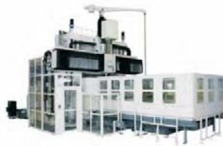
Modelo MCR-BII que cuenta con el sistema de compensación de temperaturas
