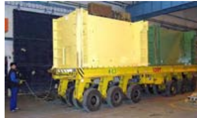
Transporte de cabezales de prensa Fuente: SMG
