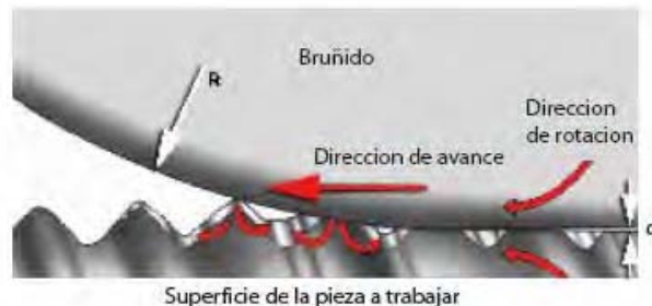
Acción del rodillo sobre la superficie a trabajar Fuente: Catálogo comercial Ecoroll
