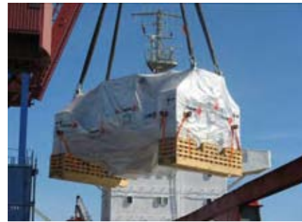
Parte de la prensa con base de madera y envuelto con embalaje retráctil Fuente: www.fagorarrasate.com
