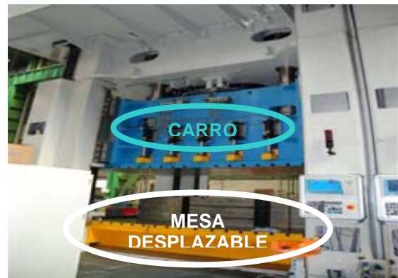
Los elementos móviles de las prensas pueden ser rediseñados con el objetivo de reducir el peso y las inercias
