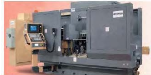
Máquina después del retrofitting Fuente: www.danobat.com
