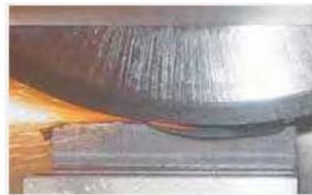
Grind hardening con refrigeración en pieza
