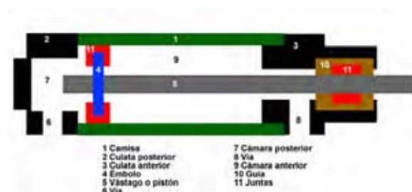
Imagen2: cilindro de acción doble. Fuente: http://sifioniche.nichese.com/cilindros-dobles.html
