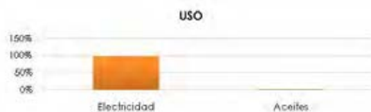
Desglose del impacto ambiental medio en fase de uso de una prensa mecánica
