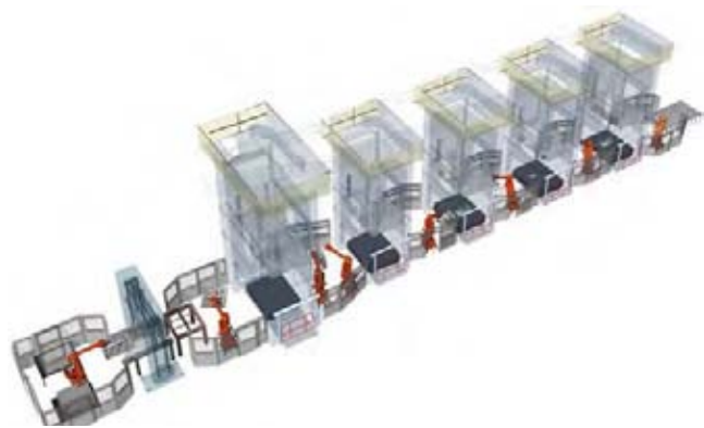
Robots de transferización de piezas entre prensas de estampación.
