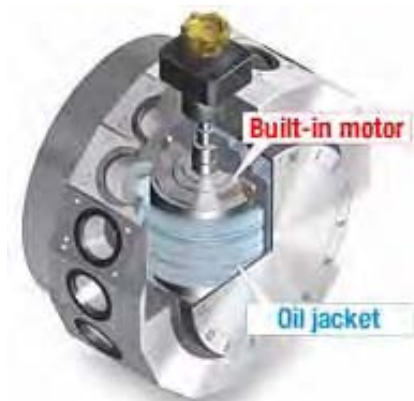
Imagen 1.- Boceto del motor built in para el giro de la herramienta. Fuente Imagen: Mori Seiki
