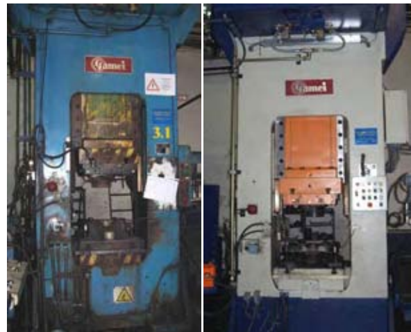
Existen varios fabricantes que utilizan viejas partes de maquinaria para adecuarlas en nuevas prensas Fuente: Servicio FAST de FAGOR ARRASATE
