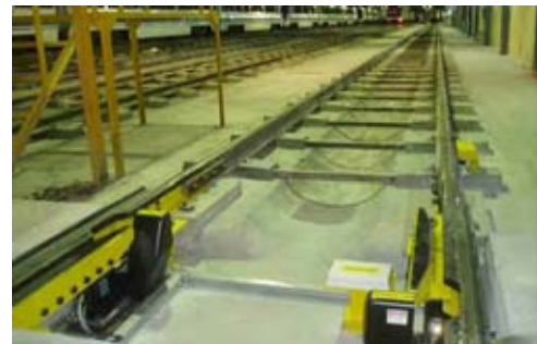
Equipo de medida de geometría de rueda con posibilidad de conectar a un torno de foso.
