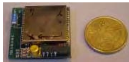
Sensor miniaturizado embebido en partes críticas de la máquina (cabezales...) Fuente: Ideko
